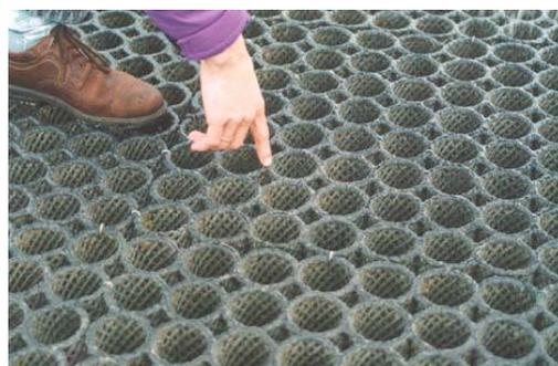
**Биофильтр BIO-BLOK®** сделан из 100% полиэтилена (по запросу может быть изготовлен из полипропилена), состоит из овальных сетчатых трубок с заданным диаметром. По мере развития биопленки на сетке каждой трубки, доступная микроорганизмам биологическая поверхность увеличивается.
