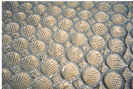
Биофильтр BIO-BLOK® имеет шероховатую поверхность, которая выполняет задачу основания для бактериальных фильтратов и других микроорганизмов, способных очищать воду от загрязняющих веществ.
